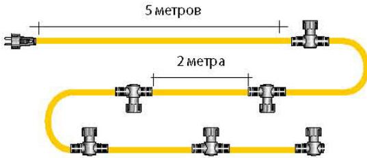
15-метровый кабель SPT-3 главных кабеля, 6 соединений, макс. 150 Вт
